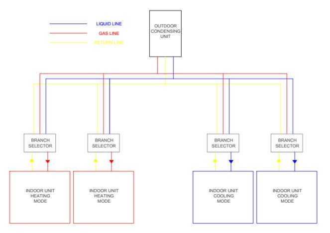
Figure 7. VRF Heat Recovery Diagram
